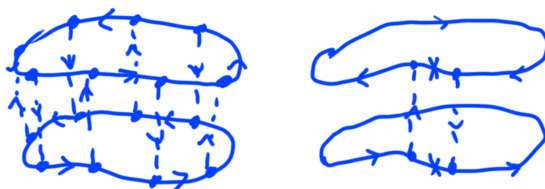
Рис. 1.9: Два варианта индуктивного перехода при построении кодов Грея
